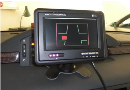
Abbildung 3; TFT-Display bei Fahrerwarnung
