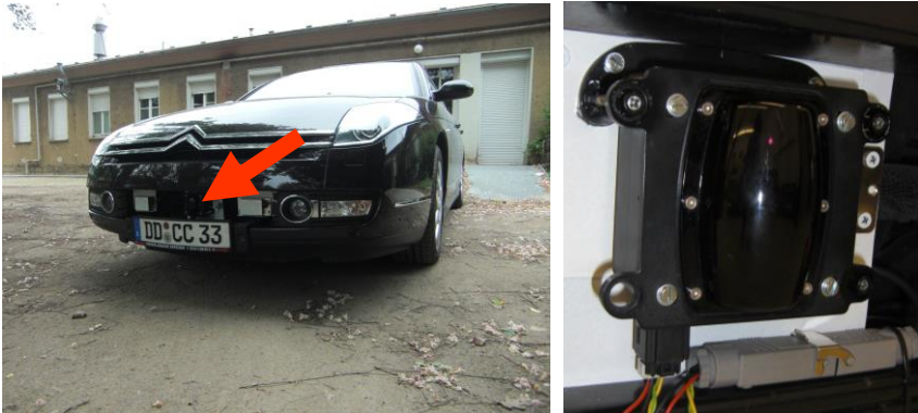
Abbildung 2; Versuchsträger mit Umfeldsensorik
